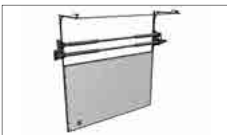
Высокий подъем, с выносным валом, двухвальная система.
