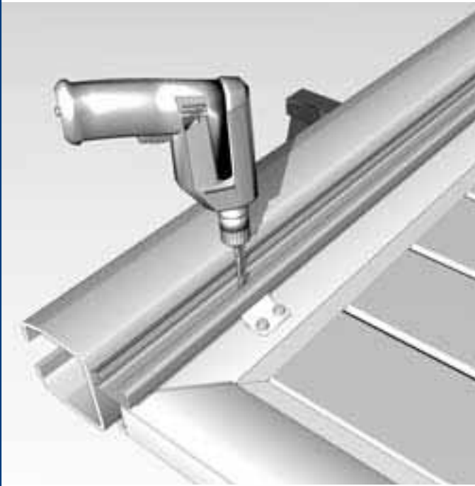
24. Профиль крепится к кронштейнам с помощью саморезов по металлу либо простыми саморезами с предварительным засверливанием.
